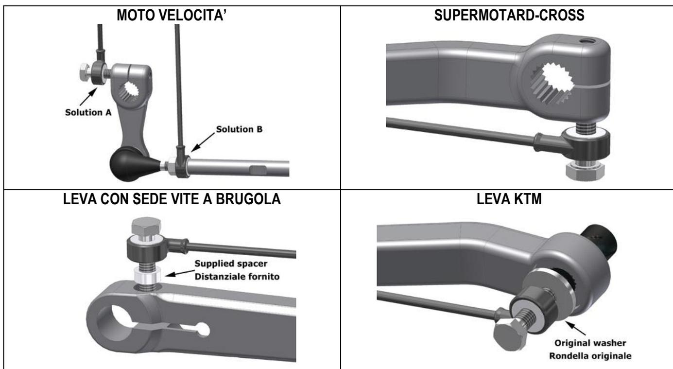
N.B.: In caso di montaggio su leve dotate di vite a brugola, inserire l'apposito distanziale fornito con il kit per compensare l'altezza della sede originale.
